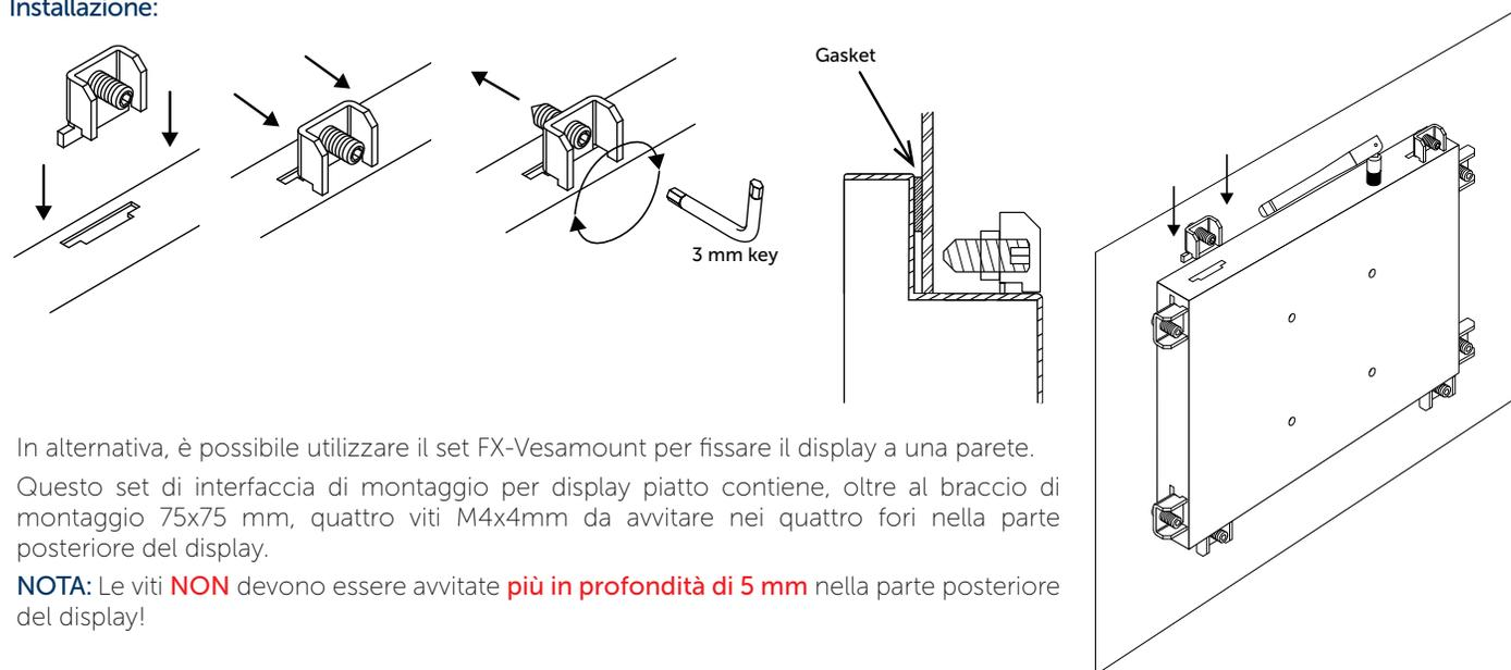
In alternativa, è possibile utilizzare il set FX-Vesamount per fissare il display a una parete. Questo set di interfaccia di montaggio per display piatto contiene, oltre al braccio di montaggio 75x75 mm, quattro viti M4x4mm da avvitare nei quattro fori nella parte posteriore del display.
